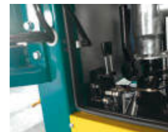
Leva di comando bandiera Control lever for suction arm Lever de contrôle pour le bras porte-tuyau d'aspiration
