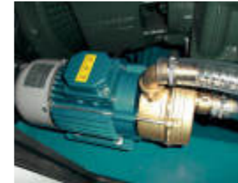
Elettropompa di adescamento Electric priming vacuum pump Pompe auto-aspirant électrique
